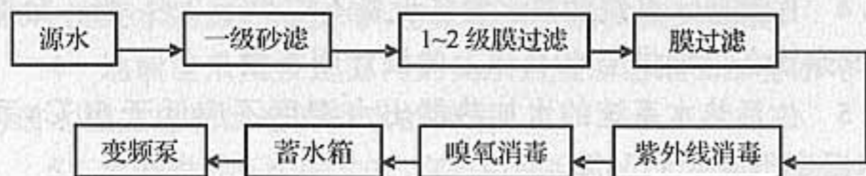
图 6.5.3 管道直饮水水处理工艺流程
